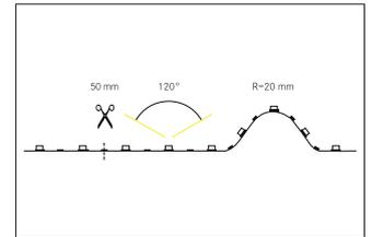
Flexplatine 5 m, COB, CRI > 90, 10 W / m, IP00, LED-Weißlicht, 2.700K, CRI > 90 LED-Flexplatine Länge: 50.0 mm Lampenleistung je Meter: 10.0 W/m, Lichtstrom je Meter: 950.0 lm/m, Schutzart raumseitig: IP00, Schutzklasse: III, Spannung: 24V DC, Abstrahlwinkel: 120.0 °, 480 LEDs pro Meter. Zur Individuellen Anwendung kann die LED-Flexplatine alle 50 mm eingekürzt werden. Die maximale Systemlänge von 5.000mm darf mit einer Einspeisung nicht überschritten werden.
