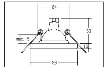
Einbaudownlight, IP65, GX5,3, edelstahl, rund. Ausgeführt in kompakter Bauform für werkzeuglose Schnellmontage zum DeckeneinbauAusführung: GX5,3, Montageart: Einbaumontage, Montageort: Deckenmontage, Material: Edelstahl / Glas, Schutzart: nach DIN EN 60529: IP65\*, Schutzklasse: (EN 61140) III, Spannung: 12V, Leistung: 35W, Anzahl der Leuchtmittel / Fassungen: 1.0 Stk, Verstellbarkeit: nicht verstellbar, ohne Betriebsgerät, Art der Dimmung: abhängig vom Betriebsgerät .
