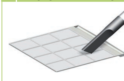
3 Reinigung mit dem Staubsauger
