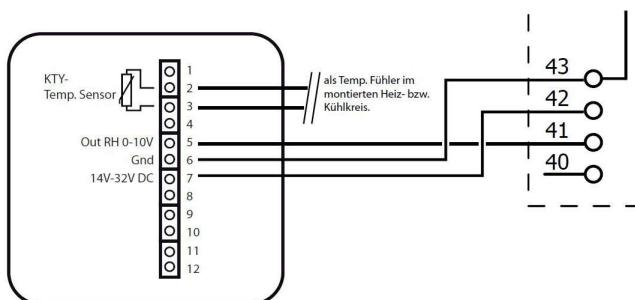
Der elektrische Anschluss erfolgt über ein flexibles 5x0,75mm<sup>2</sup> Anschlusskabel.
