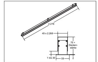
LED-Einbauprofil BIRO40, silber, rechteckig. LED-Lichtkanal mit satiniertes Abdeckung. Ausführung: LED, Montageart: Einbaumontage, Montageort: Deckenmontage, Material: Aluminium / Acryl, Schutzart: nach DIN EN 60529: IP20, Schutzklasse: (EN 61140) I, Spannung: 230V AC 50Hz, Leistung: 62.7W, Lichtstrom: 5.130lm, Farbtemperatur: von 2700 K bis 6500 K, Lichtfarbe: weiß, Abstrahlwinkel: 80°, Verstellbarkeit: nicht verstellbar, mit Betriebsgerät, Art der Dimmung: DALI .
