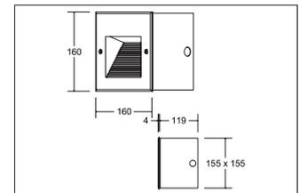
LED-Wandeinbauleuchte, IP65, strukturschwarz, rechteckig. Einbaumontage, Wandmontage Montageart: Einbaumontage, Montageort: Wandmontage, Material: Aluminium / Kunststoff, Schutzart: nach DIN EN 60529: IP65, Schutzklasse: (EN 61140) I, Spannung: 230V AC 50Hz, Leistung: 2W, Anzahl der Leuchtmittel / Fassungen: 1.0 Stk, Lichtstrom: 100lm, Farbtemperatur: 3000 K, Lichtfarbe: weiß, mit Betriebsgerät, Art der Dimmung: schaltbar .
