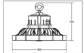
SOL Highbay 160, rund. Pendelmontage, Deckenmontage Montageart: Pendelmontage, Montageort: Deckenmontage, Material: Aluminium / Polycarbonat, Schutzart: nach DIN EN 60529: IP65, Schutzklasse: (EN 61140) I, Spannung: 230V AC 50Hz, Leistung: 160W, Lichtstrom: 25.600lm, Farbtemperatur: 4000 K, Abstrahlwinkel: 120°, mit Betriebsgerät, Dimmbar: Ja, Art der Dimmung: DALI-2 .
