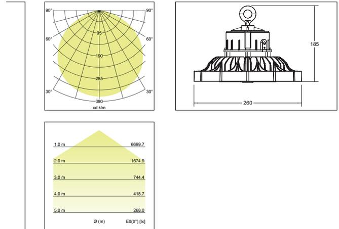
SOL Highbay 120, rund. Pendelmontage, Deckenmontage Montageart: Pendelmontage, Montageort: Deckenmontage, Material: Aluminium / Polycarbonat, Schutzart: nach DIN EN 60529: IP65, Schutzklasse: (EN 61140) I, Spannung: 230V AC 50Hz, Leistung: 120W, Lichtstrom: 19.200lm, Farbtemperatur: 4000 K, Abstrahlwinkel: 120°, mit Betriebsgerät, Dimmbar: Ja, Art der Dimmung: DALI-2 .
