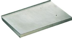
Regenschutzdach Edelstahl 1.4301, geschliffen K240 fuer Aufputz-Verteiler 700x530x350 mm (HxBxT) Zeichn.-Nr.: 15575
