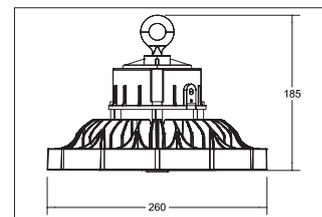
SOL Highbay 80, schwarz, rund. Pendelmontage, Deckenmontage Montageart: Pendelmontage, Montageort: Deckenmontage, Material: Aluminium / Polycarbonat, Schutzart: nach DIN EN 60529: IP65, Schutzklasse: (EN 61140) I, Spannung: 230V AC 50Hz, Leistung: 80W, Lichtstrom: 12.800lm, Farbtemperatur: 4000 K, Abstrahlwinkel: 120°, mit Betriebsgerät, Dimmbar: Ja, Art der Dimmung: DALI-2 .
