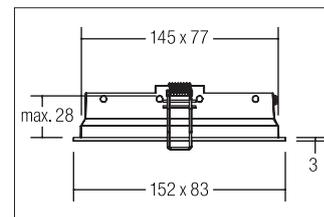
Doppel-Einbaurahmen COUPLED, rechteckig, weiß, rechteckig. Ausgeführt in kompakter Bauform für werkzeuglose Schnellmontage zum Deckeneinbau. Doppel-Einbaurahmen für Deckeneinbauleuchten COUPLED als Basis für 12640/12645, 12642/12644 und 12641/12643
