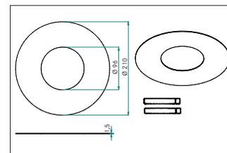
Reduzierring 210 mm, weiß, rund Reduzierring geeignet für Einbaustrahler mit Montagefedern.
