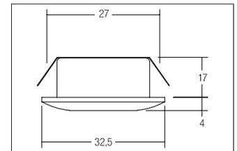
LED-Lichtpunkt, IP44, chrom, rund. Ausgeführt in kompakter Bauform für werkzeuglose Schnellmontage zum Deckeneinbau-
