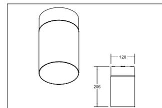
Wandanbauleuchte, strukturschwarz, rund. Ausführung in kompakter Bauform für die harmonische Implementierung in stimmige, architektonische Raumkonzepte. Ausführung: E27, Montageart: Anbaumontage, Montageort: Deckenmontage, Material: Aluminium / Glas / Kunststoff, Schutzart: nach DIN EN 60529: IP65, Schutzklasse: (EN 61140) I, Spannung: 230V AC 50Hz, Leistung: 8W, Abstrahlwinkel: 360°, Verstellbarkeit: nicht verstellbar, ohne Betriebsgerät, Art der Dimmung: sonstige .
