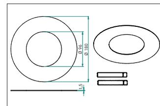
Reduzierring 180 mm, nickel matt, rund Reduzierring geeignet für Einbaustrahler mit Montagefedern.
