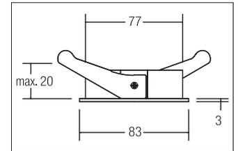
Einbauring COUPLED, rund, weiß, rund. Ausgeführt in kompakter Bauform für werkzeuglose Schnellmontage zum Deckeneinbau. Einbauring für Deckeneinbauleuchten COUPLED als Basis für 12630/12635, 12632/12634 und 12631/12633
