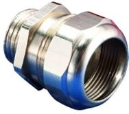
Extra dichte mehrteilige Metall-Schlauchverschraubung mit Innentülle, Dichtung und starrem Anschlussgewinde, zur Montage von passenden Schutzschläuchen. Ausgelegt nach den Vorschriften der EN 60204 für den Maschinen- und Anlagenbau.
