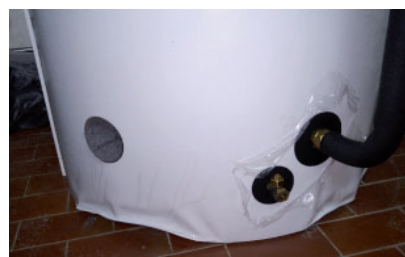
Abb.: Schaden an der Isolierung, verursacht durch unsachgemäÙe Lagerung.
