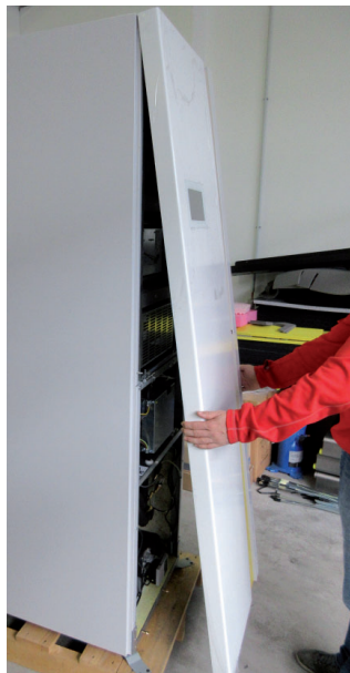
Mit Schraubenzieher die Verriegelung lösen
