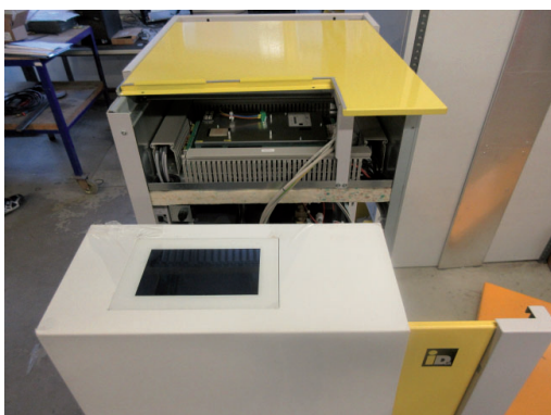
Verbindungskabel zum Bedienteil ausstecken
