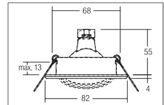
Einbaustrahler, GX5,3, schwarz, rund. Ausgeführt in kompakter Bauform für werkzeuglose Schnellmontage zum Deckeneinbau-
