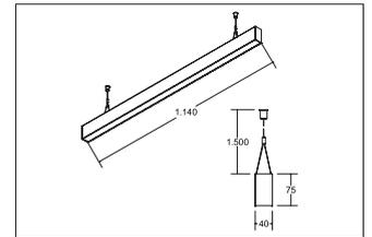
LED-Pendel-Profilleuchte direkt BIRO40, silber, rechteckigAusführung: LED, Montageart: Pendelmontage, Montageort: Deckenmontage, Material: Aluminium / Acryl, Schutzart: nach DIN EN 60529: IP20, Schutzklasse: (EN 61140) I, Spannung: 230V AC 50Hz, Leistung: 31.4W, Lichtstrom: 2.570lm, Farbtemperatur: von 2700 K bis 6500 K, Lichtfarbe: weiß, Abstrahlwinkel: 80°, Verstellbarkeit: nicht verstellbar, mit Betriebsgerät, Art der Dimmung: DALI .
