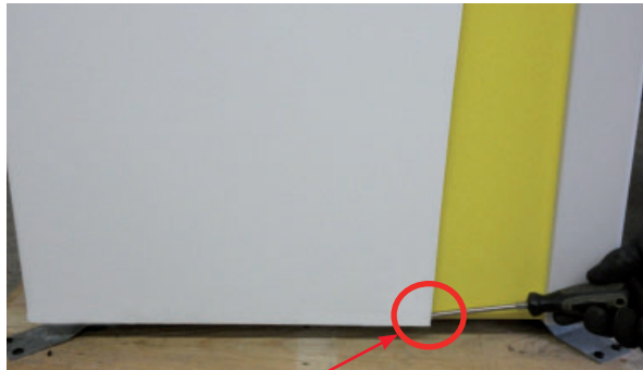
Mit Schraubenzieher die Verriegelung lösen
