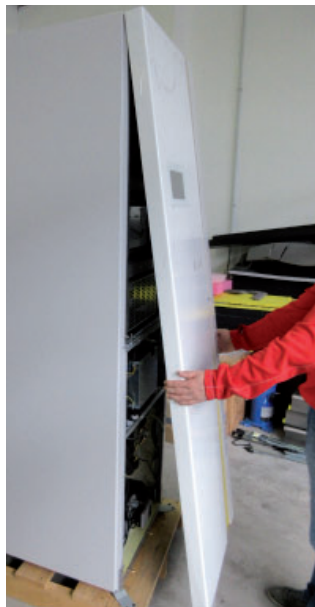
Mit Schraubenzieher die Verriegelung lösen
