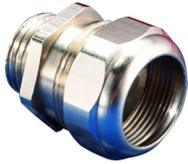
Extra dichte mehrteilige Metall-Schlauchverschraubung mit Innentülle, Dichtung und starrem Anschlussgewinde, zur Montage von passenden Schutzschläuchen. Ausgelegt nach den Vorschriften der EN 60204 für den Maschinen- und Anlagenbau.
