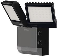
LED-Strahler für Wandmontage mit Bewegungsmelder, schwarz, 4000 K, 2x900 lm, 2 LED-Strahler mit insgesamt 17 W, Erfassungsbereich 180° 10 m, zusätzlicher Schaltausgang Licht, vernetzbar über Draht
