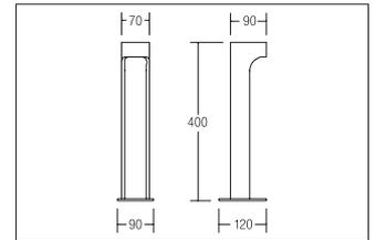
LED-Pollerleuchte IP54, strukturweiß. Ausführung in kompakter Bauform für die harmonische Implementierung in stimmige, architektonische Raumkonzepte.
