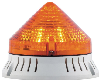
SIRENA Blitzleuchte mit akust. Signal CTLXA9001J1F, 12/24V AC/DC, IP30, orange
