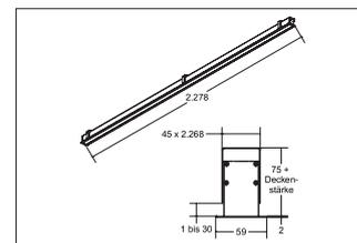
LED-Einbauprofil BIRO40, schwarz, rechteckig. LED-Lichtkanal mit satiniertem Abdeckung. Ausführung: LED, Montageart: Einbaumontage, Montageort: Deckenmontage, Material: Aluminium / Acryl, Schutzart: nach DIN EN 60529: IP20, Schutzklasse: (EN 61140) I, Spannung: 230V AC 50Hz, Leistung: 62.7W, Lichtstrom: 5.130lm, Farbtemperatur: von 2700 K bis 6500 K, Lichtfarbe: weiß, Abstrahlwinkel: 80°, Verstellbarkeit: nicht verstellbar, mit Betriebsgerät, Art der Dimmung: DALI .
