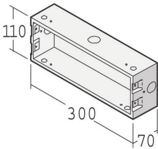
RENTZ UP-Kasten für Audio-Sprechanlage BxHxT 300x110x70mm
