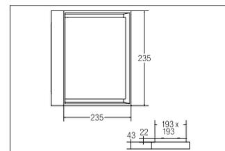
LED-Wand- & Deckenanbauleuchte, IP54, strukturschwarz, quadratisch. Einbaumontage, Wandmontage Montageart: Einbaumontage, Montageort: Wandmontage, Material: Aluminium / Acryl, Schutzart: nach DIN EN 60529: IP54, Schutzklasse: (EN 61140) I, Spannung: 230V AC 50Hz, Leistung: 14W, Anzahl der Leuchtmittel / Fassungen: 1.0 Stk, Lichtstrom: 1.230lm, Farbtemperatur: 3000 K, Lichtfarbe: weiß, Abstrahlwinkel: 110°, mit Betriebsgerät, Art der Dimmung: schaltbar .
