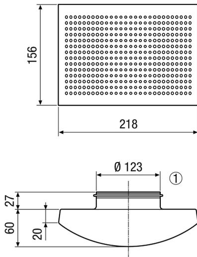
① Anschlussstutzen mit Gummidichtung
