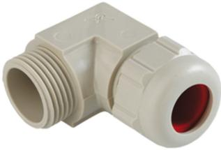
Winkel-Kabelverschraubungen 90° Kunststoff, Anschlussgewinde Pg, Grau RAL 7032 Kabel Ø 7.0-10.5 mm
