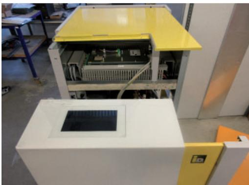
Verbindungskabel zum Bedienteil ausstecken
