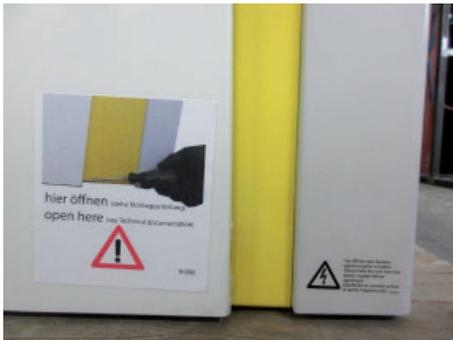
Um das Frontteil öffnen und abnehmen zu können, muss die Verriegelung mit einem Schraubenzieher oder einem spitzen Gegenstand gelöst werden. Die Verriegelung befindet sich hinter der weißen Abdeckung, ungefähr einen Zentimeter oberhalb der Gerätekante. Durch Drücken des Verriegelungsbolzens löst sich die Verriegelung des Frontteils. Das Frontteil kann nun unten herausgezogen und durch leichtes Anheben oben ausgehängt und abgenommen werden.
