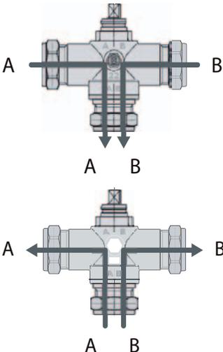
Das manuelle Verstellen des zylindrischen Kugelventils ist nur möglich, wenn der Stellantrieb demontiert ist. Das manuelle bedienen des Ventils ist dann sinnvoll, wenn das Leitungssystem neu gefüllt, entleert oder entlüftet werden soll oder aber auch wenn der Elektromotor nicht mehr funktionsfähig ist (z.B. durch Stromausfall) oder sich die Anlage im Notheizbetrieb befindet (siehe Anleitung für den Montage u. Betriebsanleitung WP)
