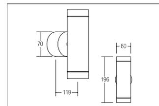
Wandanbauleuchte, V4A, IP44, edelstahl, rund. Ausführung in kompakter Bauform für die harmonische Implementierung in stimmige, architektonische Raumkonzepte. Lichtaustritt direkt und indirekt. Ausführung: GU10, Montageart: Anbaumontage, Montageort: Wandmontage, Material: Edelstahl V4A / Glas, Schutzart: nach DIN EN 60529: IP44, Schutzklasse: (EN 61140) I, Spannung: 230V AC 50Hz, Leistung: 35W, Anzahl der Leuchtmittel / Fassungen: 2.0 Stk, Art der Dimmung: sonstige .
