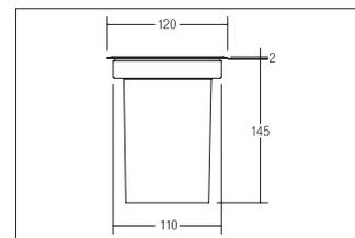
Bodeneinbauleuchte, GU10 (für LED), IP65, edelstahl, rund. Einbaumontage, BodenmontageAusführung: GU10, Montageart: Einbaumontage, Montageort: Bodenmontage, Material: Edelstahl / Glas, Schutzart: nach DIN EN 60529: IP65, Schutzklasse: (EN 61140) II, Spannung: 230V AC 50Hz, Leistung: 5W, Anzahl der Leuchtmittel / Fassungen: 1.0 Stk, Art der Dimmung: sonstige .
