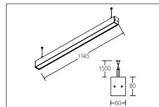
LED-Pendelprofileuchte BIRO60, mikroprismatische Abdeckung, silber eloxiert, rechteckig. Ausführung in kompakter Bauform für die harmonische Implementierung in stimmige, architektonische Raumkonzepte. Optik: Mikroprismen
