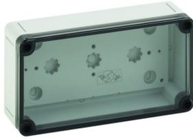
Leergehäuse TK PS 1809-6-to, Leergehäuse, Kasten: Polystyrol, grau, ähnlich RAL 7035, Deckel: Polycarbonat, transparent, Schutzart IP66, mit Schutzgrad IK07, Schutzklasse II, Bemessungsisolationsspannung  $U_i$  690VAC/DC,  $U_i$ =1000VDC, Halogenfrei, 180 x 94 x 57, ohne Vorprägungen,
