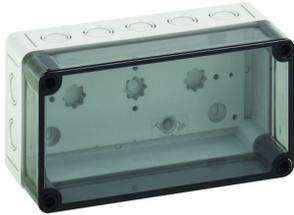
Leergehäuse TK PS 1809-8-tm, Leergehäuse, Kasten: Polystyrol, grau, ähnlich RAL 7035, Deckel: Polycarbonat, transparent, Schutzart IP66, mit Schutzgrad IK07, Schutzklasse II, Bemessungsisolationsspannung  $U_i$  690VAC/DC,  $U_i$ =1000VDC, Halogenfrei, 180 x 94 x 81, mit metrischen Vorprägungen,
