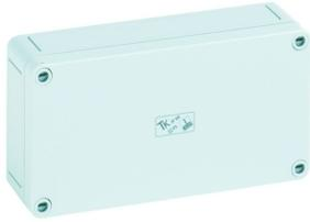
Leergehäuse TK PS 1809-6-o, Leergehäuse, Kasten und Deckel: Polystyrol, grau, ähnlich RAL 7035, Schutzart IP66, mit Schutzgrad IK07, Schutzklasse II, Bemessungsisolationsspannung  $U_i$  690VAC/DC,  $U_i=1000$ VDC, Halogenfrei, 180 x 94 x 57, ohne Vorprägungen,
