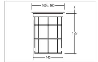
LED-Bodeneinbauleuchte, IP65, edelstahl. Einbaumontage, Bodenmontage Montageart: Einbaumontage, Montageort: Bodenmontage, Material: Edelstahl / Aluminium / Glas, Schutzart: nach DIN EN 60529: IP65, Schutzklasse: (EN 61140) I, Spannung: 230V AC 50Hz, Leistung: 6W, Anzahl der Leuchtmittel / Fassungen: 1.0 Stk, Lichtstrom: 500lm, Farbtemperatur: 3000 K, Lichtfarbe: weiß, Abstrahlwinkel: 38°, Verstellbarkeit: schwenkbar, mit Betriebsgerät, Art der Dimmung: schaltbar .
