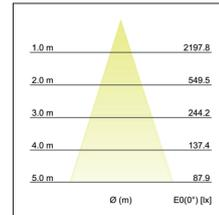
LED-Bodeneinbauleuchte, V4A, IP67, edelstahl, rund. Einbaumontage, Bodenmontage. Montageart: Einbaumontage, Montageort: Bodenmontage, Material: Edelstahl V4A / Aluminium / Glas, Schutzart raumseitig: nach DIN EN 60529: IP67, Schutzklasse: (EN 61140) I, Spannung: 230V AC 50Hz, Leistung: 12W, Anzahl der Leuchtmittel / Fassungen: 1.0 Stk, Lichtstrom: 1.050lm, Farbtemperatur: 3.000 K, Abstrahlwinkel: 38°, ohne Betriebsgerät, Art der Dimmung: schaltbar.
