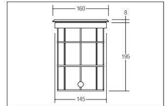
LED-Bodeneinbauleuchte, IP65, edelstahl, rund. Einbaumontage, Bodenmontage. Montageart: Einbaumontage, Montageort: Bodenmontage, Material: Edelstahl / Aluminium / Glas, Schutzart raumseitig: nach DIN EN 60529: IP65, Schutzklasse: (EN 61140) I, Spannung: 230V AC 50Hz, Leistung: 5W, Anzahl der Leuchtmittel / Fassungen: 1.0 Stk, Lichtstrom: 500lm, Farbtemperatur: 3.000 K, Abstrahlwinkel: 38°, Verstellbarkeit: schwenkbar, mit Betriebsgerät, Art der Dimmung: schaltbar.
