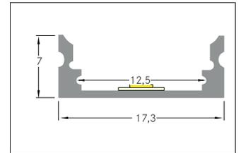
Anbau - Aluminiumprofil - Komplettset, alu eloxiert. Abmessung Profil: L: 2.500 mm x B: 17,3 mm x H: 7 mm.
