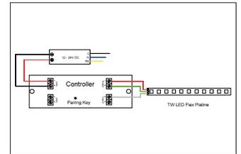
TunableWhite-Funksteuerung zur Ansteuerung von zweifarbigen LED-Modulen im Weißlichtbereich.
