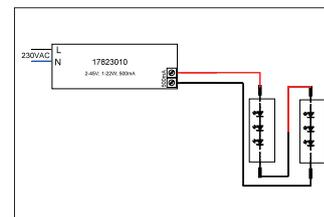
LED-Konverter 500 mA, schaltbar. Dieser Konverter ist durch Sicherungseinrichtungen gegen Überspannung und Kurzschluss sowie thermische und elektrische Überlastung geschützt. Die Eingangs- und die Ausgangsklemme ist für Leitungen mit einem Querschnitt von bis zu 1,5 mm<sup>2</sup> geeignet.. Material: Kunststoff, Schutzart raumseitig: nach DIN EN 60529: IP20, Schutzklasse: (EN 61140) II, Spannung: 230V AC 50Hz , Leistung: 22W, Art der Dimmung: schaltbar.
