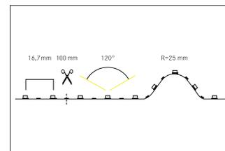
LED-Flexplatine, 30 m, CRI > 95, 3,0 W / m, IP00, LED-Weißlicht, 3.000K, CRI > 95 LED-Flexplatine zur dekorativen, technischen, sowie effizienten Beleuchtung von Lichtvouten, Linearanwendungen und Hinterleuchtungen, Grund- bzw. Allgemeinbeleuchtung von Räumen, architektonische Anwendungen und für Bereiche, in denen eine hohe Ausleuchtung gewünscht ist, wie z.B. indirekte oder direkte Beleuchtungen, Lichtdecken, Gastronomiebeleuchtungen und vielem mehr. Länge: 30000.0 mm
