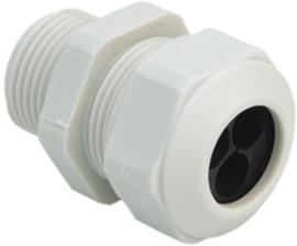
Kabelverschraubungen Progress® Kunststoff GFK für mehrere Kabel, Anschlussgewinde metrisch, Multidichteinsatz Kabel 2x Ø 5.5-7.5 mm
