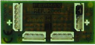
**FERMAX Erweiterungsmodul für den Anschluss von bis zu 8 Ruftasten**
