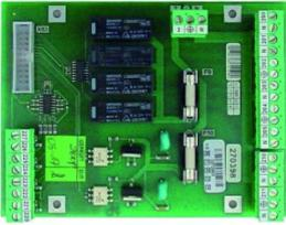
IDM Heizkreiserweiterungsmodul intern für 2 Heizkreise inkl. Fühler
